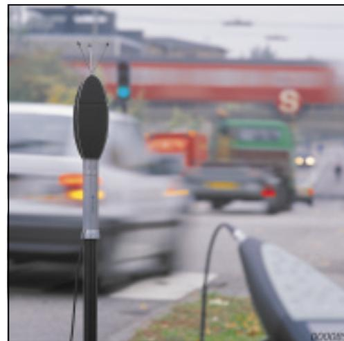
*Para hacer mediciones no asistidas, el micrófono necesita protección contra el viento, la lluvia y ¡los pájaros! También tiene que ser fácilmente accesible para su calibración e inspección*
