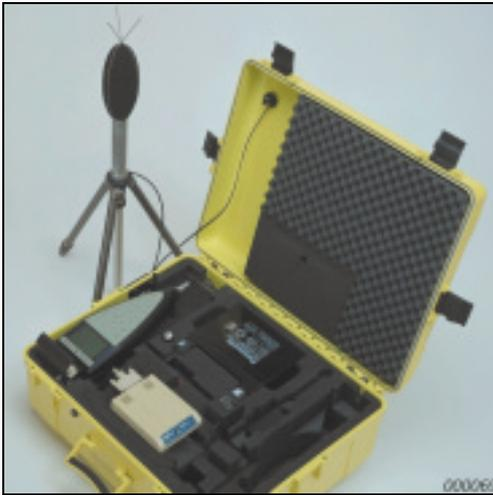
La unidad GPS (Sistema de Posicionamiento Global) transfiere las coordenadas de localización del lugar al sonómetro, para integrarse con los datos de nivel de sonido
