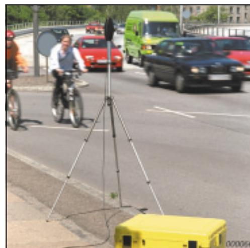
*También puede utilizarse un sonómetro para mediciones no asistidas si se le añade un elemento protector -aquí se muestra alojado en una maleta con batería extra, grabadora DAT para identificar fuentes de ruido, módem GSM para el volcado de datos de mediciones a un PC desde la oficina*
