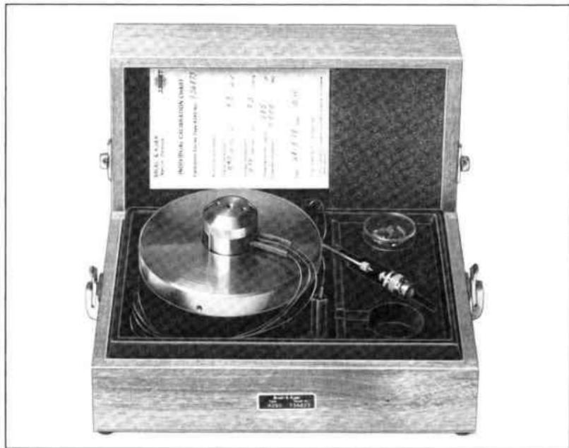
Fig. 5.14. Excitateur d'étalonnage Type 4290
