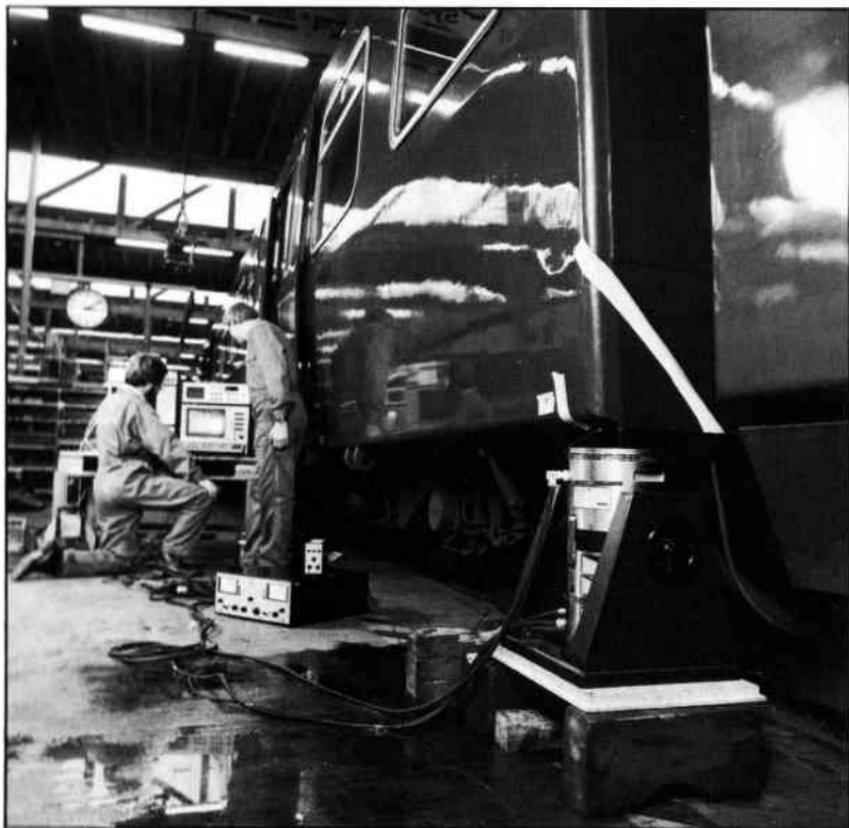
*Fig. 1.3. Analyse structurelle d'un wagon de train à partir de mesures de vibrations*
