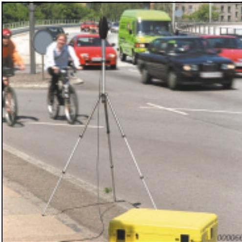
*Le sonomètre peut être logé dans une mallette de protection qui contient également une batterie de réserve, un enregistreur audio-numérique pour identifier les sources sonores, et un modem GSM pour télécharger les mesures dans un PC situé dans le bureau de l'opérateur*
