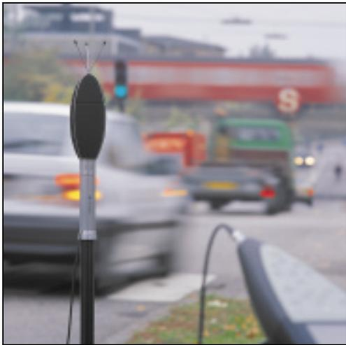
*Pour la télé-surveillance, le microphone doit être protégé des oiseaux et des intempéries. Il doit aussi être facilement accessible à l'occasion des inspections et des vérifications de calibrage*
