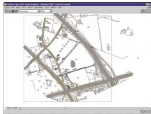
*Modèle simple de jonction d'axes routiers, avec routes, sols acoustiquement durs, contours topographiques et quelques points acoustique d'évaluation en facade d'immeubles*
