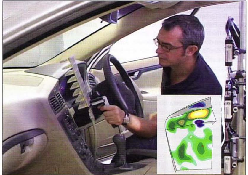
**Bild 29** Datenerfassung im Fahrzeug und Kartierung der Mittelkonsole.
