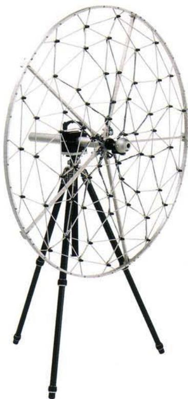
**Bild 27** 60-Kanal-Combo-Sektor-Wheel-Array für Beamforming und SONAH Messungen.
