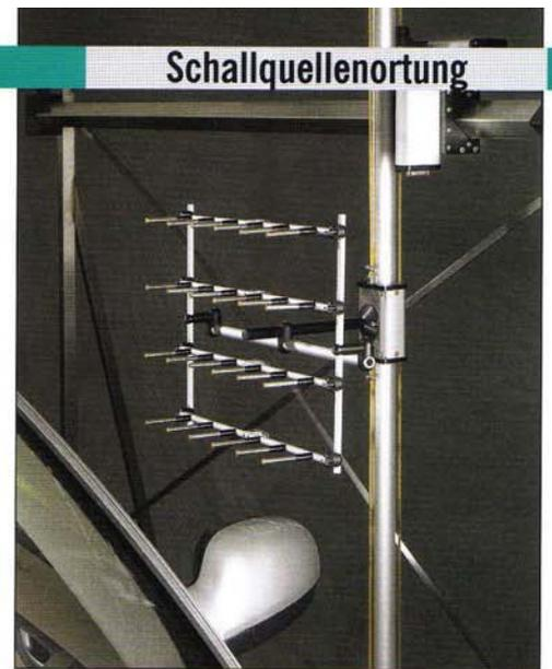
Bild 20 STSF-Array mit Roboter.
