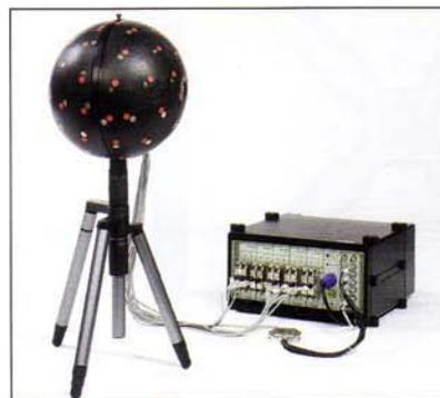
**Bild 12** Spherical Beamforming Array mit 40 Mikrofonen und zwölf Kameras inkl. PULSE Messsystem.
