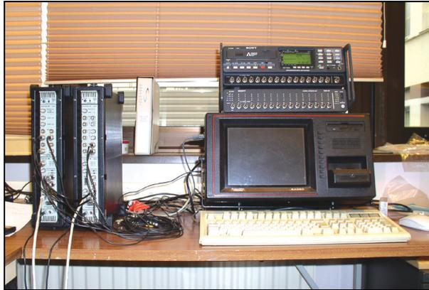
“Possiamo sia registrare le misure per il successivo post processing in laboratorio sia analizzare in tempo reale. Se abbiamo necessità di più di 12 canali o se il campione temporale dura più di 1 ora registriamo il segnale su un registratore digitale Sony DAT che rappresenta la nostra unità di espansione che ci consente la misura sino a 64 canali; e tutte le misure sono dinamiche.”
