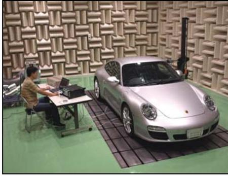
半無響室は浮き構造で、暗騒音は7 dBA以下となっており、天井に設置された空調により温度制御され、車両を空ぶかしした状態でも実験できる排気ダクトなどの設備も備えられています。部屋の扉は高さ3.5mで、大型の製品や部品を運び込むこともできます。半無響室を含む測定実施エリア4ヶ所は各々独立して機密が保持できる構造になっており、お客様の機密事項を確実に保証しています。土地と建物を合わせて約5億円投資されており、PULSE D フレーム4台、LAN-XI D フレーム1台、Test for Ideas ソフトウェア、そのほか各種トランスデューサなど、多くのプレミアム・ケア製品がそろっています。
